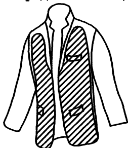
Рисунок 1.25 — Схема расположения обрабатываемых участков левой и правой полочек пиджака
